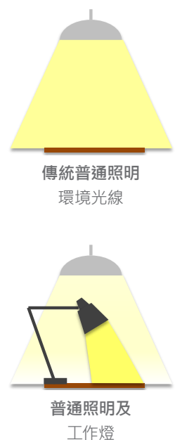
圖3.3.13 使用工作燈照明的圖解
