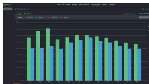
安裝電子整流風機前後的配風系統用電量比較
