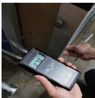
新鴻基中心現有過濾器 - 0.0701 kPa 壓降
