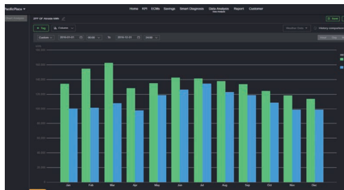
风系统 电子换相风机安装前后的电耗对比
